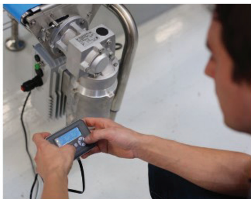
Die Installation des Frequenzumrichters direkt auf dem Motor erhöht die Flexibilität und vereinfacht die Wartung und Instandhaltung der Nord-Antriebe.
